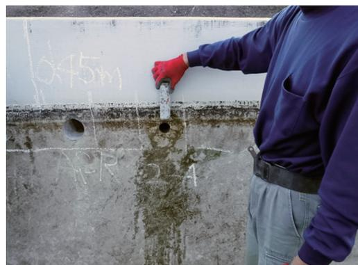
写真は、機能診断調査の一部でコンクリート水路から試料を採取している状況です。採取した試料でコンクリート強度を測定し、併せて、コンクリート表面に現れているひび割れの有無を確認しています。
